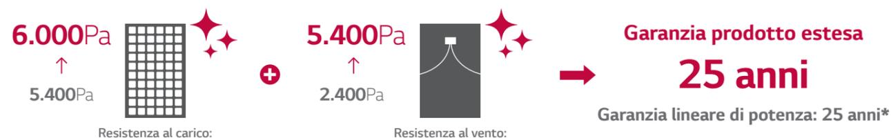
\* Il modulo è completamente conforme alle nuove procedure di test IEC 61215-2: 2016 che hanno confermato 5.400 Pa di carico frontale e 4.000 Pa di carico posteriore. LG ha effettuato test interni per confermare 6.000 Pa carico frontale e 4.000 Pa carico posteriore anche con le nuove norme IEC 61215-2: 2016. Ulteriori test sono in corso. A meno che questi test non risultino diversamente, LG conferma 6.000 Pa/5.400 Pa.
